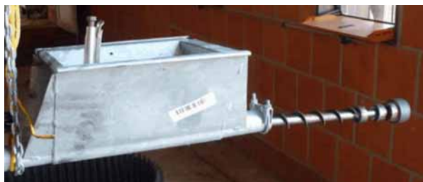
Figure 6-6 : Vis spirale sur l'arbre de tension
