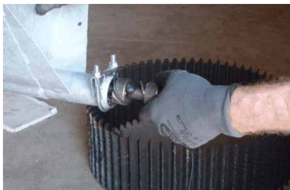
Figure 6-8 : Maintenir l'arbre de tension
