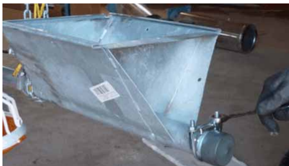
Figure 6-2 : Desserer la vis en U
