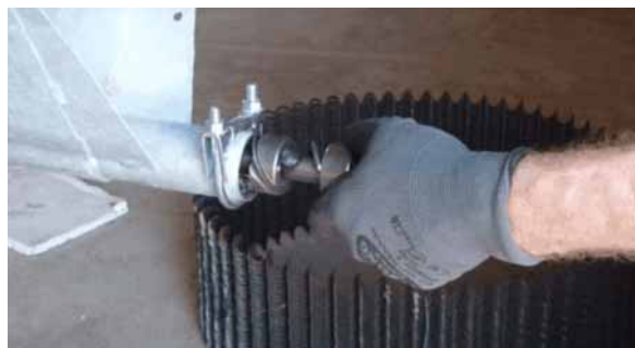
Figure 6-3 : Enlever l'arbre de tension
