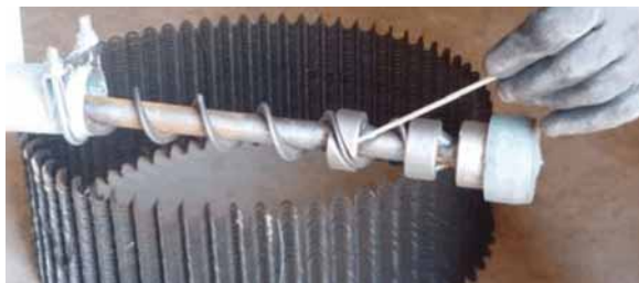
Figure 6-5 : Desserrez la vis transporteuse de l'arbre de tension
