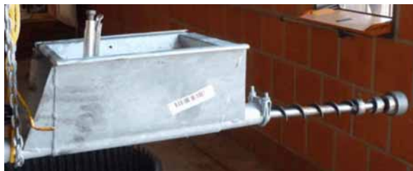
Figure 6-4 : Fixer la vis transporteuse avec une pince-étau
