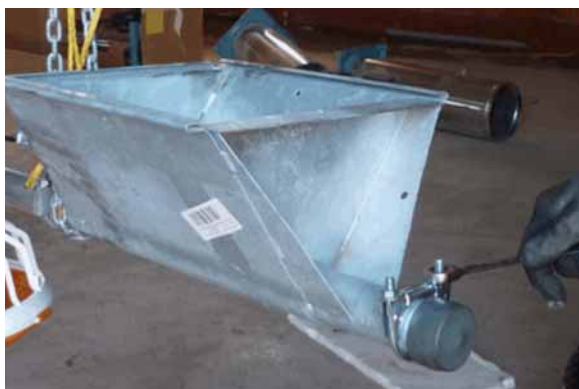
Figure 6-9 : Fixer l'arbre de tension
